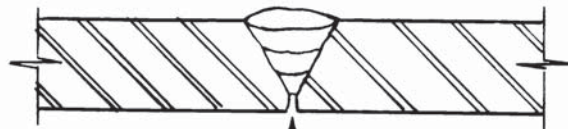
(d) Incomplete Penetration of Weld Groove
